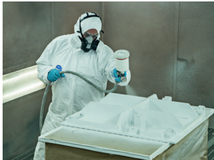
FERTIG BESCHICHTETER DECKEL MIT THERMO- UND KORROSIONSSCHUTZBESICHTUNG.
