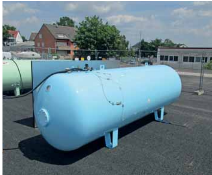
Versuchsaufbau zur Erfassung von Druck- und Temperaturmesswerten am blauen Behälter.
